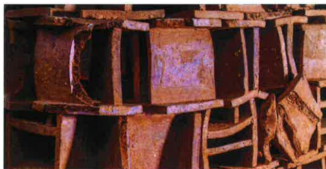
Carreaux de Courboissey : les variantes de couleurs vont du rouge profond au noir métallisé en fonction de la température et de l'atmosphère oxydante ou réductrice.
